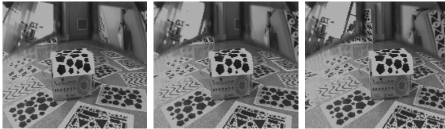
Figura 3.10: Sequência de imagens com obstáculo para um movimento de rotação puro do robot móvel (1 a , 3 a e 5 a imagens).
