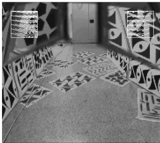
Figura 4.3: Fluxo óptico típico obtido para as duas janelas correspondentes aos campos visuais periféricos (de notar que os vectores de fluxo têm um sentido oposto ao esperado, isto deve-se ao efeito de reflexão introduzido pelo sistemas de espelhos do sensor).
